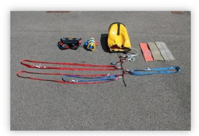
A l'issue de chaque intervention, la corde est sortie entièrement du sac. Une vérification **visuelle et tactile** est faîtes après chaque utilisation sur la totalité de la corde. Puis « enquitée » (en vrac) dans le sac en inversant la terminaison soudée, celle qui était placée sur le sauveteur est positionnée au fond du sac.
