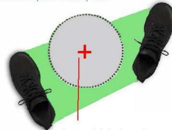
Le centre de gravité de la charge doit être au plus près de mon centre de gravité (l'idéale étant de les superposer)
