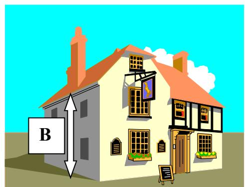
La longueur de la corde après le dernier point de renvoi doit toujours être inférieure à cette hauteur de manière à pouvoir stopper la chute du sauveteur avant qu'il ne heurte un obstacle.
