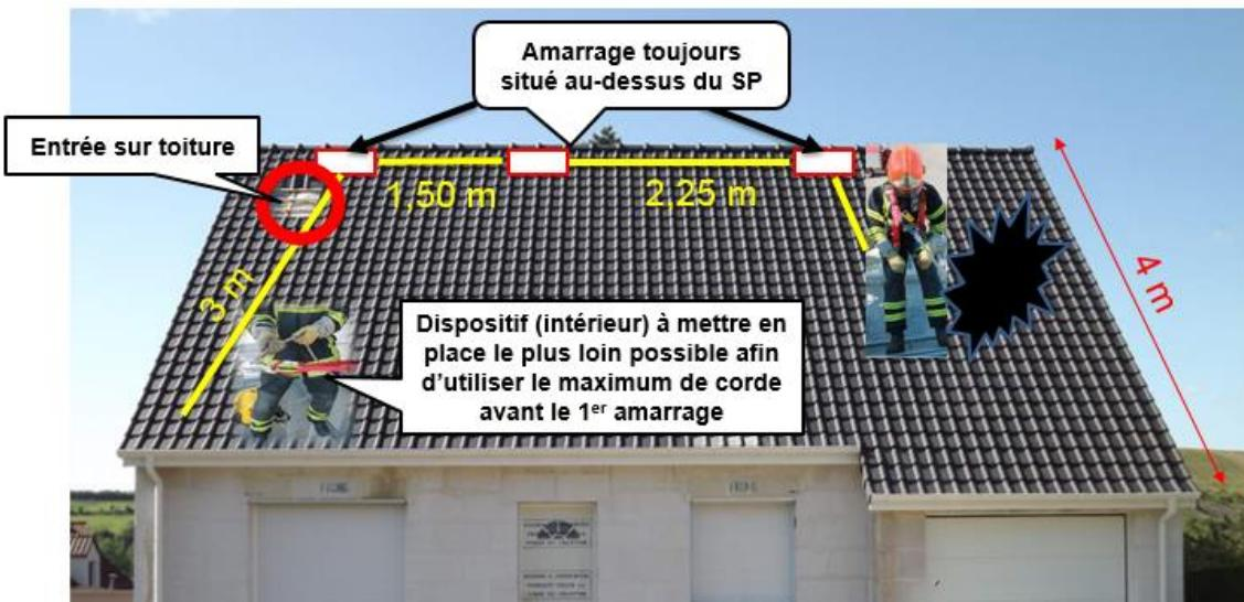
Rappel : Les dispositifs d'amarrage doivent impérativement être au-dessus du SP ou au même niveau de l'axe de déplacement, de manière à travailler en sécurité (travail en-dessous des points d'amarrage ou à niveau mais jamais au-dessus).
