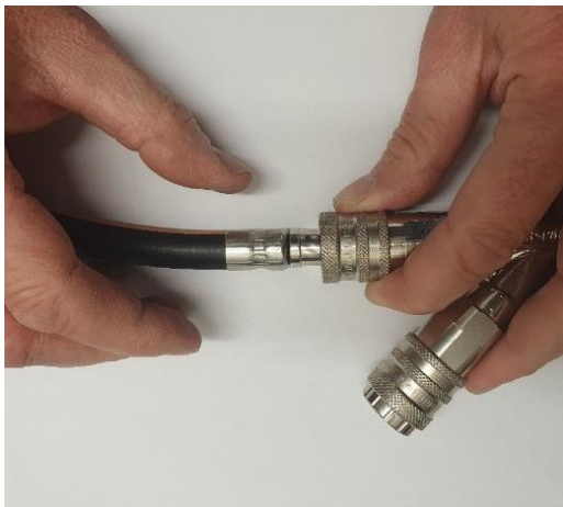
2. L'enfoncer à l'intérieur du raccord femelle
