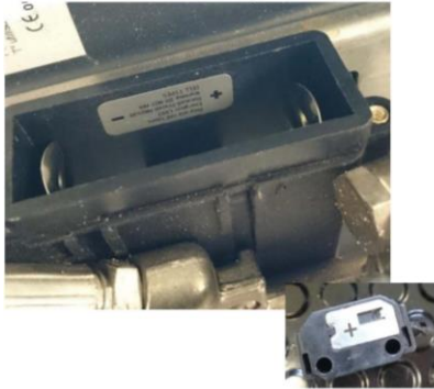
Un + et un - sont visibles, gravés de chaque côté du bloc piles
